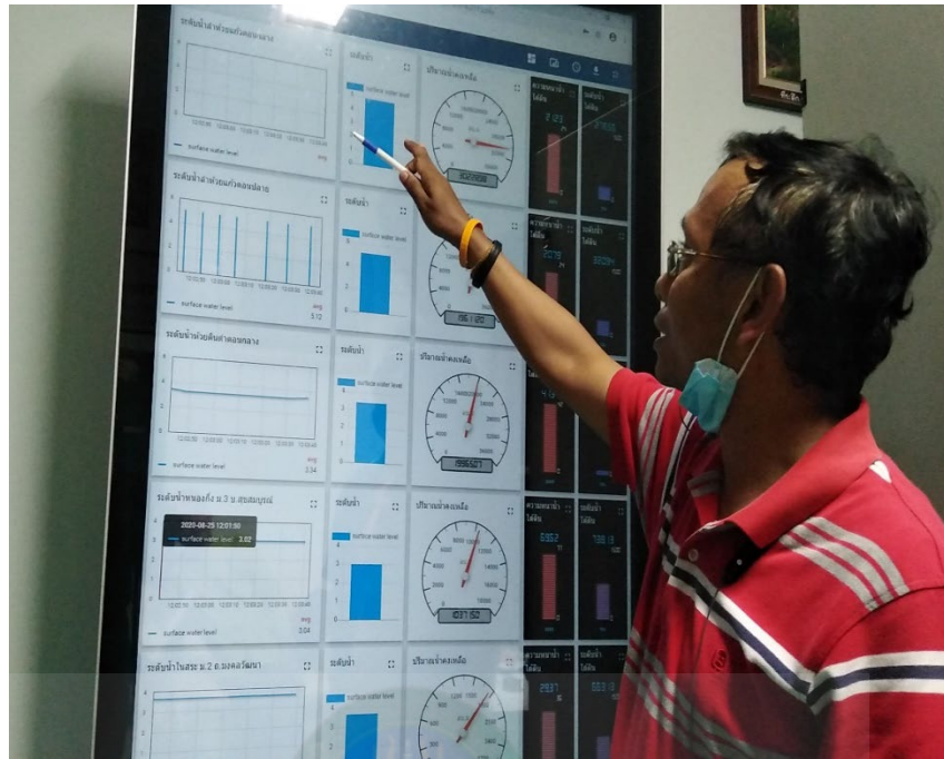
ภาพที่ ค.21 ตรวจสอบระดับน้ำด้วย APPLICATION IOT
