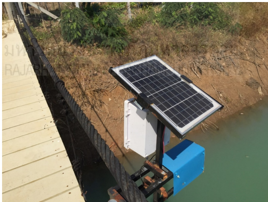
ภาพที่ ค.22 อุปกรณ์ IOT เพื่อรับส่งสัญญาณแต่ละจุดในการอ่านระดับน้ำแต่ละจุด
