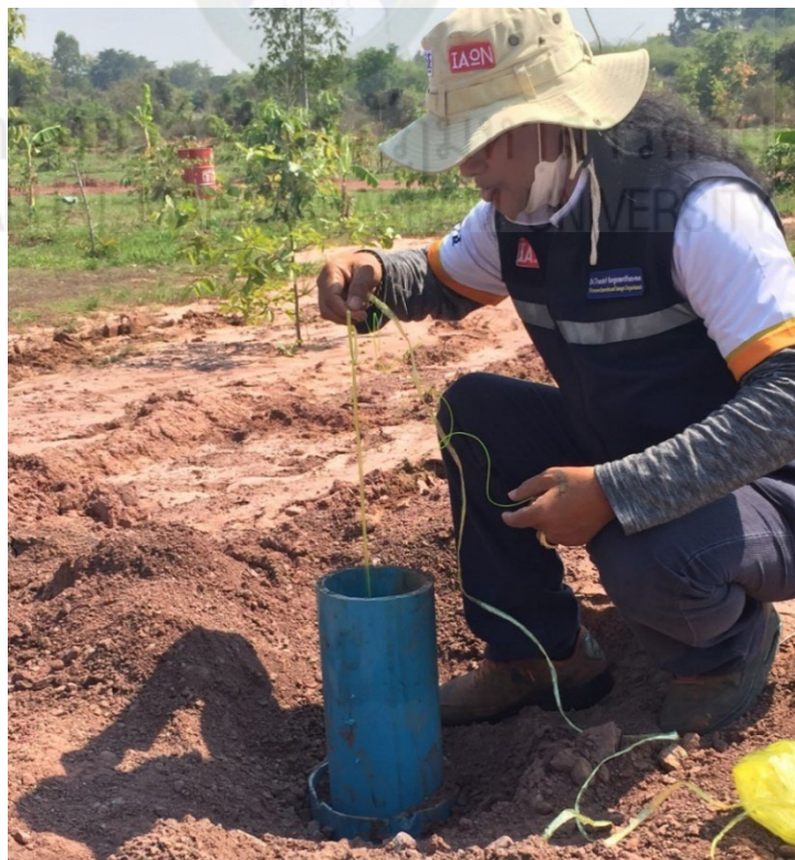
ภาพที่ ค.20 ตรวจสอบระดับน้ำในบ่อสังเกตการณ์ (บ่อบาดาล)
