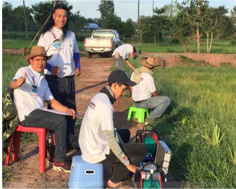
ภาพที่ 4.9 การปฏิบัติการสำรวจธรณีฟิสิกส์ด้วยวิธีหาค่าความต้านทานไฟฟ้าจำเพาะของชั้นดิน
