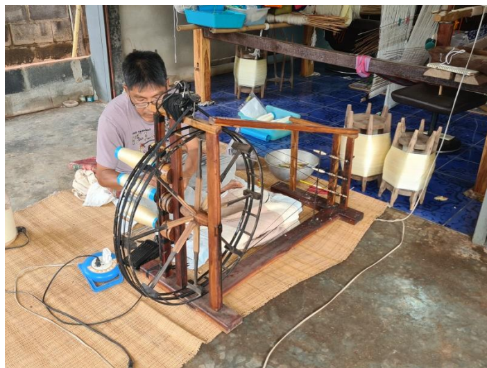
ภาพ 7 อุปกรณ์สำหรับทอผ้าที่เรียกว่าหลา สำหรับปั่นเส้นไหมใส่ในหลอด แหล่งที่มา: ญัฐวดี รอดภัย 3 มีนาคม 2564
