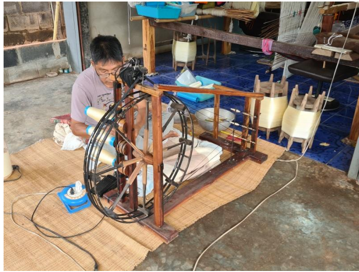
ภาพ 7 อุปกรณ์สำหรับทอผ้าที่เรียกว่าหลา สำหรับปั่นเส้นไหมใส่ในหลอด แหล่งที่มา: ณีรัฐดี รอดภัย 3 มีนาคม 2564
