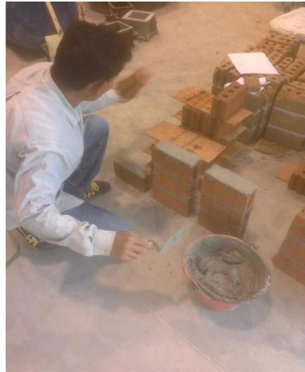
ภาพที่ ก-7 ทำการก่ออิฐตัวอย่างเพื่อทดสอบกำลังรับแรงอัดของก้อนอิฐมอญซีเมนต์
