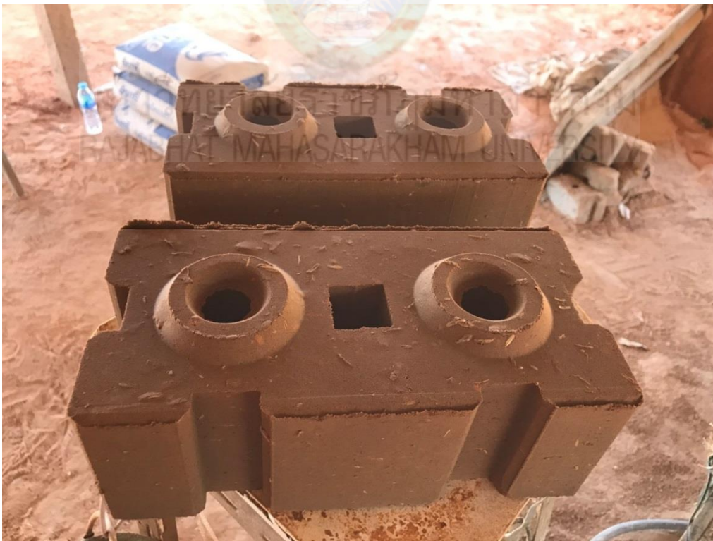
ภาพที่ ก.5 การผลิตอิฐบล็อกประสานแทนที่ด้วยดินลมหอบและแกลบ
