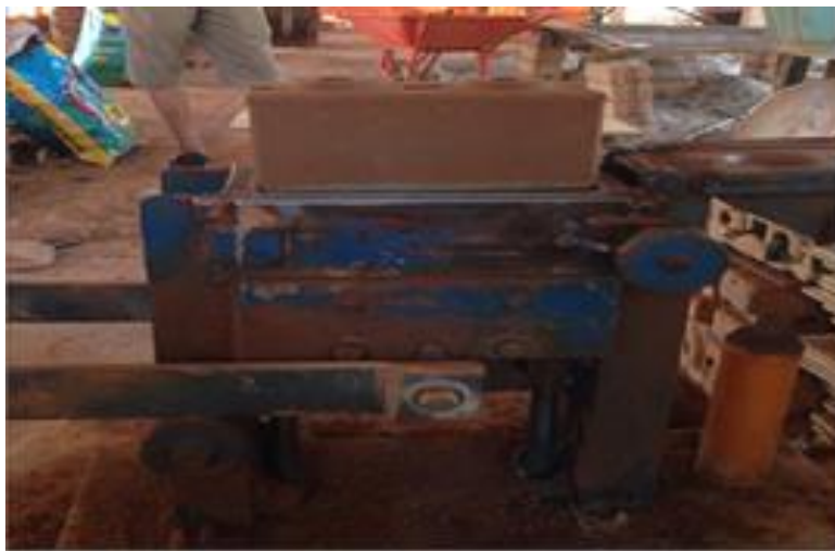
ภาพที่ 2.4 เครื่องอัดบล็อกประสานโดยใช้แรงคน
