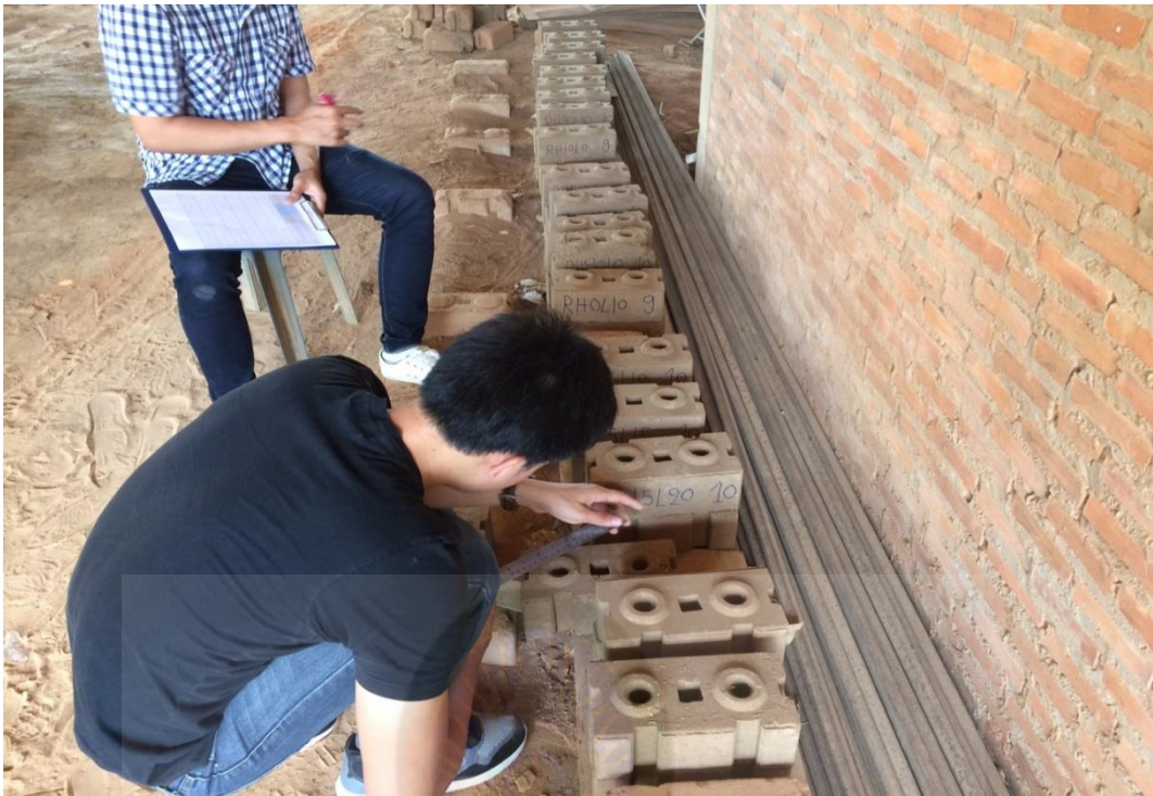
ภาพที่ ก.8 วัดขนาดเพื่อหาค่ามิติ
