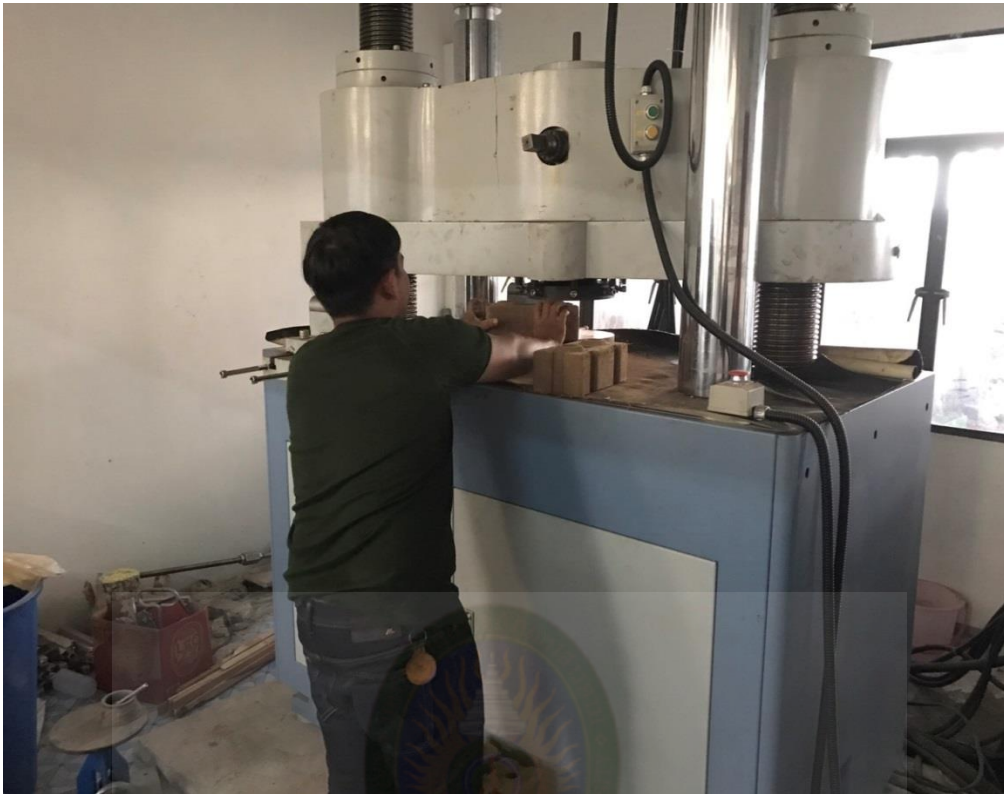
ภาพที่ ก.10 ทดสอบค่าความต้านแรงอัดของอิฐบล็อกประสาน ที่อายุ 7 วัน และ 28 วัน
