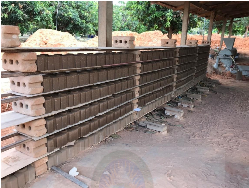
ภาพที่ ก.6 นำอิฐบล็อกประสานมาเรียงแล้วตากผึ่งลมในที่ร่มให้แห้ง
