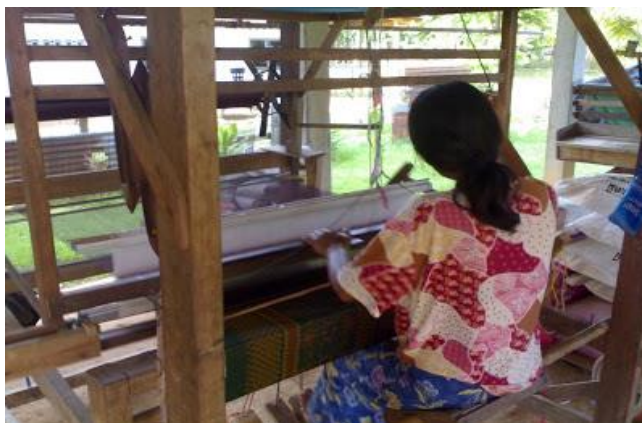
ภาพที่ 4.18 กี่กระตุก (ข้อมูลสารสนเทศการทอผ้าอีสาน)
