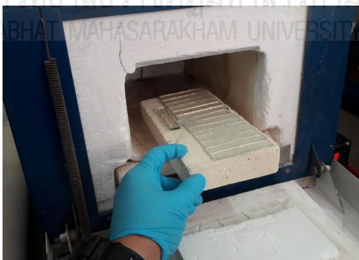
รูปที่ 3.11 แสดงการนำตัวอย่างไปเผาในเตาเผาอุณหภูมิสูง
