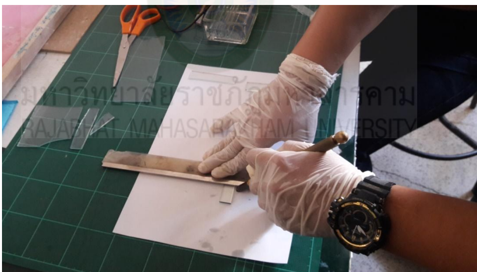
รูปที่ ก. 11 แสดงการตัดกระจกนำไฟฟ้าเพื่อเตรียมแผ่นรองรับ
