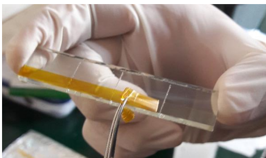
รูปที่ 3.5 แสดงการดึงเทปสำหรับมาร์คกิ้ง (kapton tape) ออก
