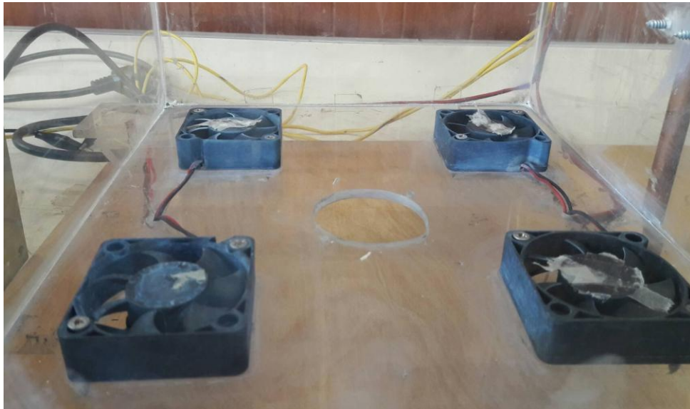
รูปที่ ก. 2 แสดงการติดตั้งพัดลมจับแผ่นรองรับอุปกรณ์
