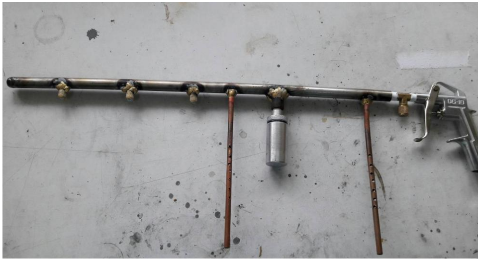
รูปที่ ก. 8 แสดงการเชื่อมต่อหัวฉีดพ่น กระบอกใส่สาร และปืนลมกดปล่อยแรงดัน
