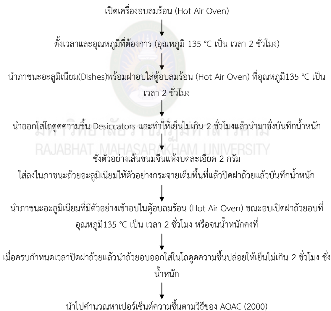
ภาพที่ 3.3 ขั้นตอนการวัดคุณภาพของเส้นขนมจีนแห้งโดยวัดความชื้น
