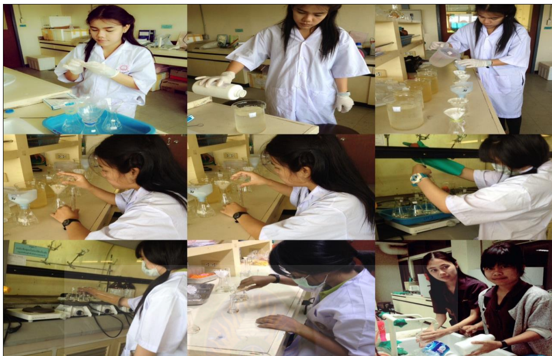
ภาพที่ ง-7 แสดงวิธีการย่อยตัวอย่างน้ำเพื่อนำไปหาโลหะหนัก
