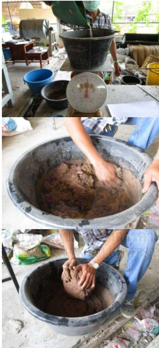
ภาพภาคผนวกที่ 3 การผสมและนวดดินให้เข้ากัน
