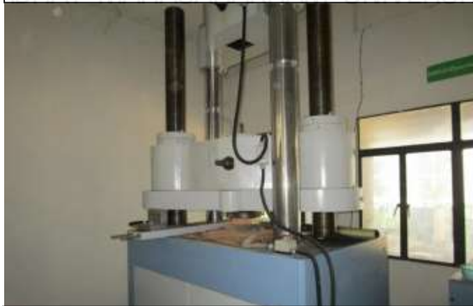
ทดสอบอิฐด้วยเครื่องทดสอบ
