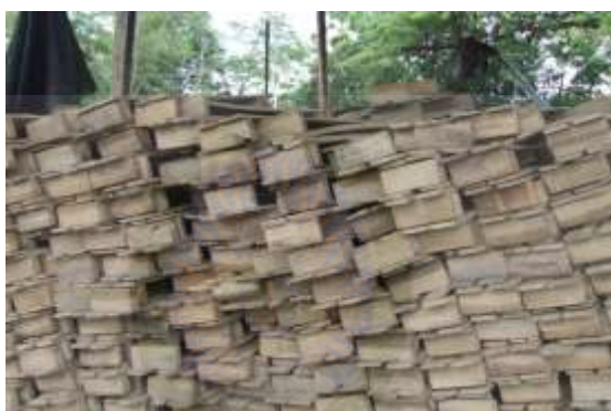
ภาพที่ 2 แสดงแบบที่ใช้ในการผลิตอิฐ (สุทัศน์ จันบัวลา และคณะ. 2554)
