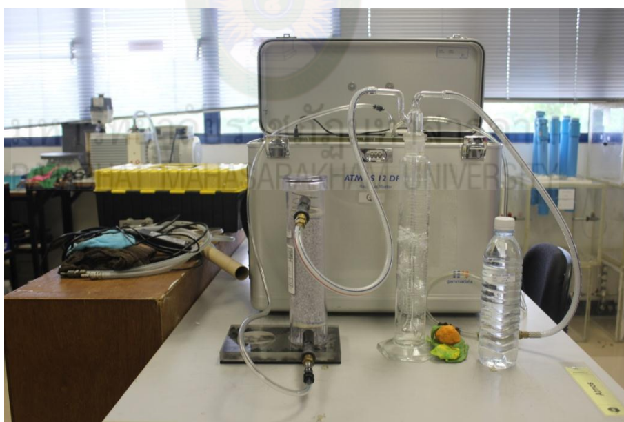
รูปที่ จ-6 รูปแสดงเครื่อง Atmos 12 DPX ที่ใช้ในการวิเคราะห์ตัวอย่างน้ำ ของสถาบันเทคโนโลยี นิวเคลียร์แห่งชาติ
