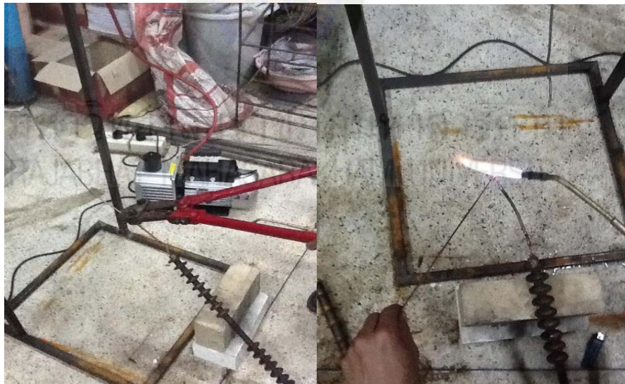
รูปที่ ค-4 การตัดและปิดหัวท่อที่เต็มสารเสร็จ
