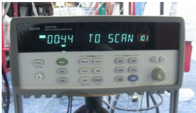
รูปที่ 3.5 เครื่องบันทึกข้อมูล (Data Logger)
