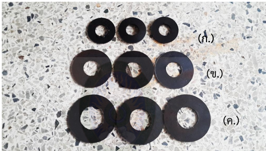
รูปที่ ค-1 ครีบน้ำขนาดต่างที่ใช้ติดในการทดสอบ (ก.) ความสูงครีบน้ำ 5 มิลลิเมตร (ข.) ความสูงครีบน้ำ 10 มิลลิเมตร (ค.) ความสูงครีบน้ำ 15 มิลลิเมตร
