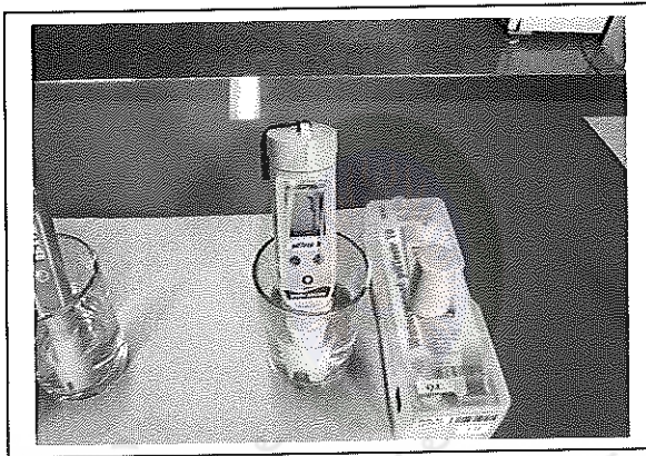
ภาพภาคผนวกที่ 7 เครื่องวัด ค่าพีเอช แบบพกพา
