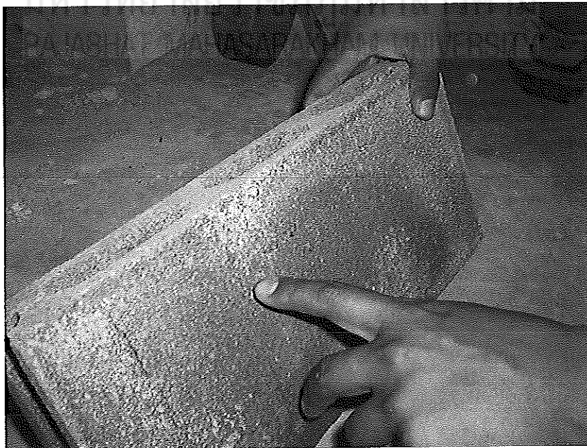
อิฐบล็อกที่ทำการอัดแรงแล้ว
