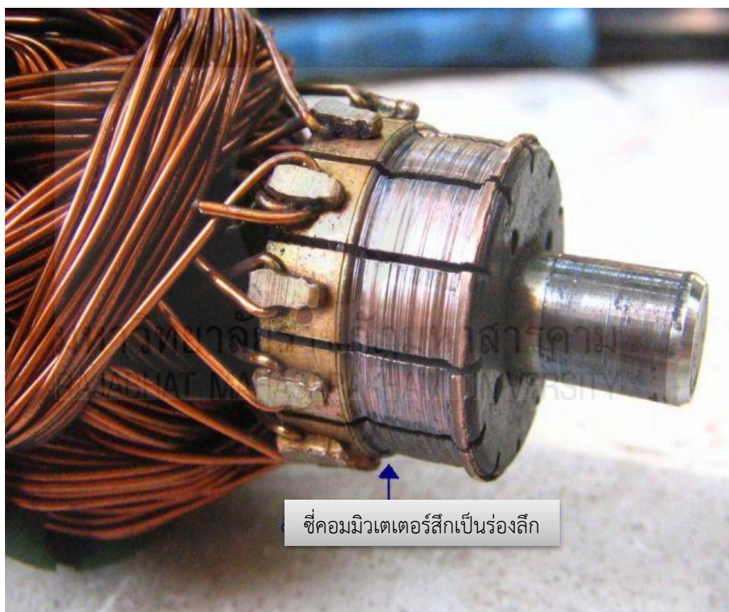
ภาพที่ 2.21 รูปลักษณะของคอมมิวเตเตอร์เมื่อประกอบขึ้นด้วยแผ่นทองแดงเรียงอัดเป็นรูปวงแหวนติดกับแกนในแล้ว ที่มา (ทศพล บุญใส, 2559)
