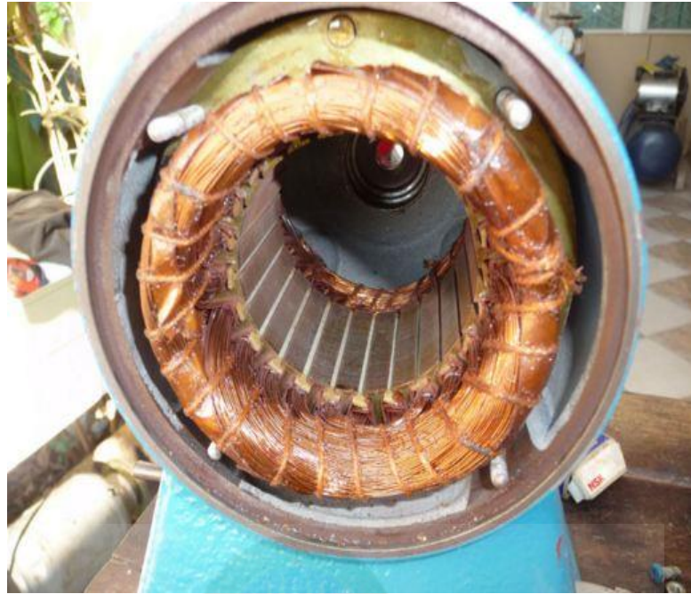
ภาพที่ 2.27 ขดลวดสนามแม่เหล็ก ที่มา (ทศพล บุญใส, 2559)
