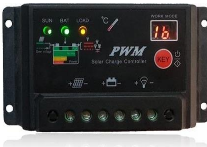
ภาพที่ 2.44 แสดงระบบไฟแสดงสถานะแผงโซลาร์เซลล์ ที่มา (พรชัย พรหฤทัย, 2557)
