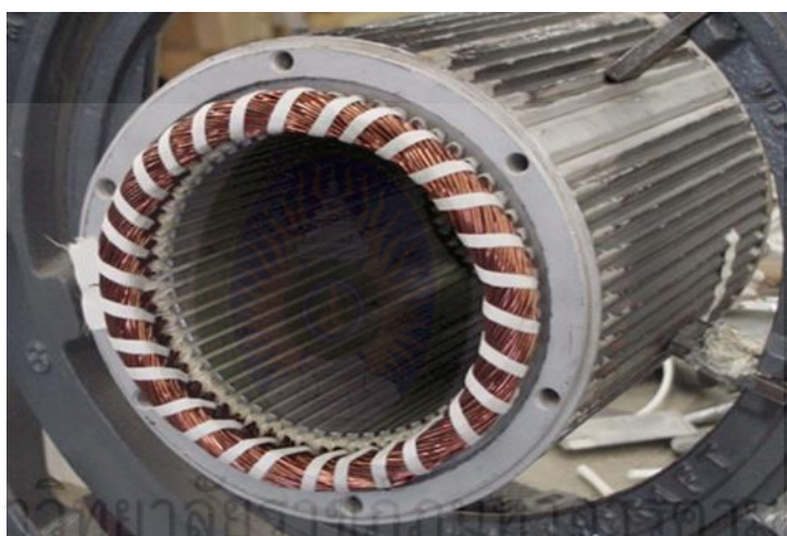
ภาพที่ 2.2 แกนเหล็กสเตเตอร์และขดลวดสเตเตอร์
