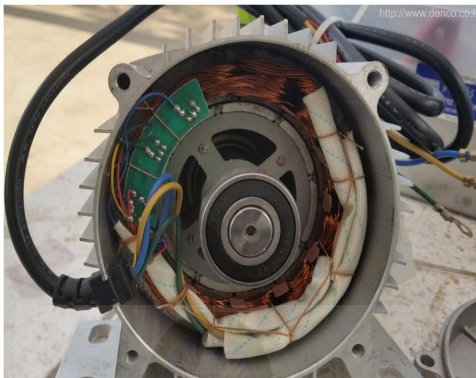
ภาพที่ 2.17 โครงมอเตอร์ซึ่งประกอบด้วย ขั้วสนามแม่เหล็ก 4 ขั้ว ที่มา (ทศพล บุญใส, 2559)
