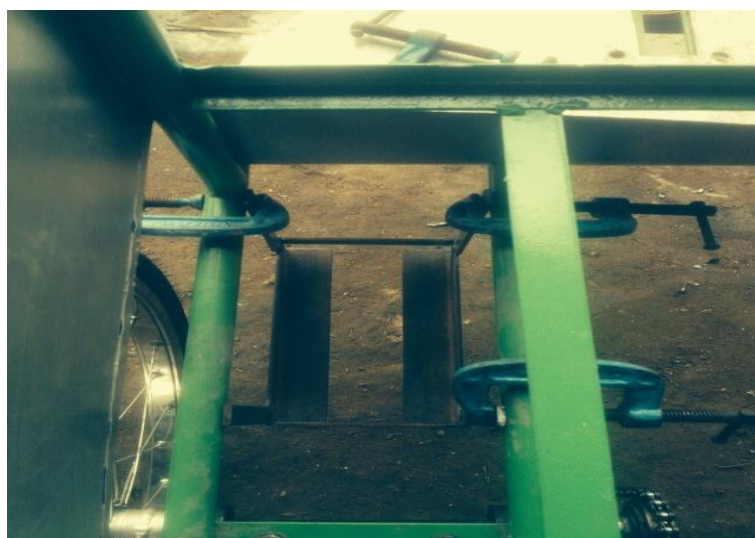
ภาพที่ 3.2 เชื่อมที่วางแบตเตอรี่
