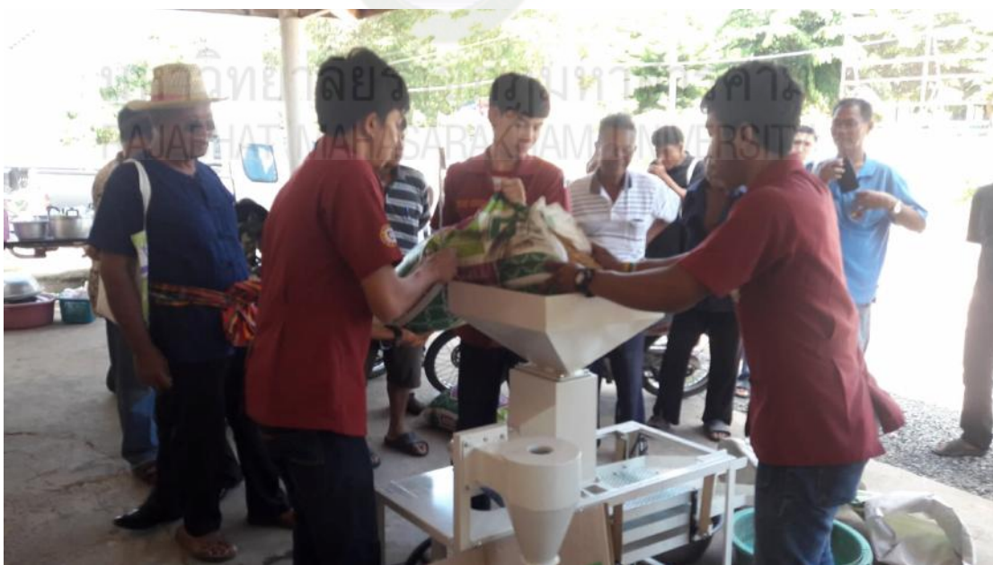
ภาพที่ 4.10 สาธิตการใช้งานเครื่องคัดแยกเมล็ดพันธุ์ข้าว 2
