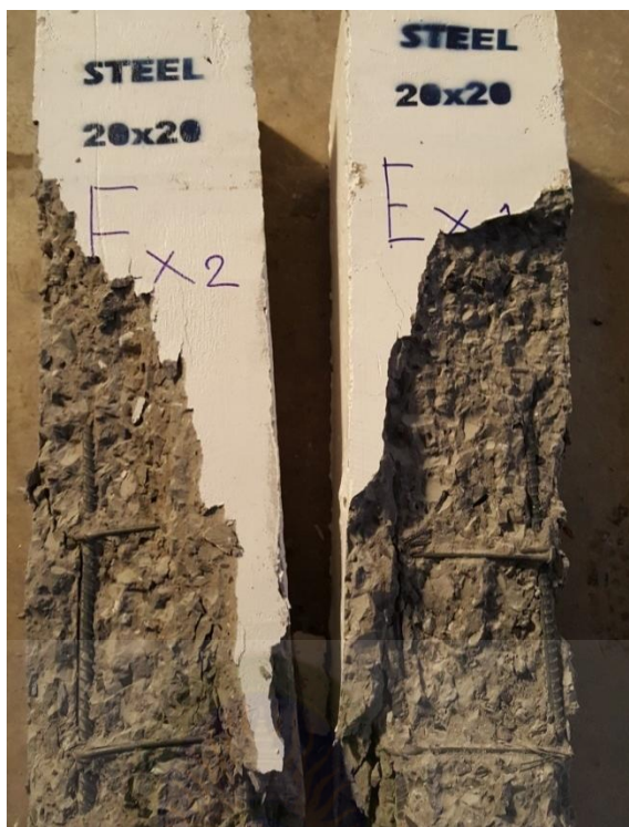
ภาพประกอบที่ 43 การวิบัติของเสาคอนกรีต
