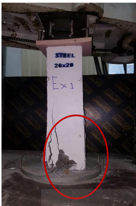
ภาพประกอบที่ 27 รูปแบบการวิบัติของเสาคอนกรีต ขนาด 20x20 เซนติเมตร
