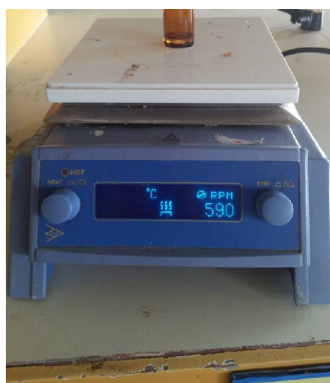
รูปที่ ก (4) เครื่องกวนสารละลายพร้อมเตาให้ความร้อน (Hotplate and magnetic stirrer) ยี่ห้อ: IKA รุ่น : C-MAG HS7
