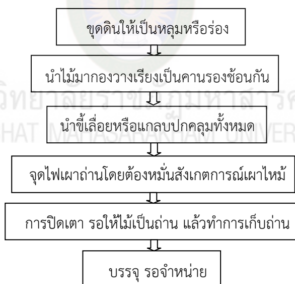
รูปที่ 2.11 แสดงขั้นตอนการเผาถ่านด้วยเตาลาน
