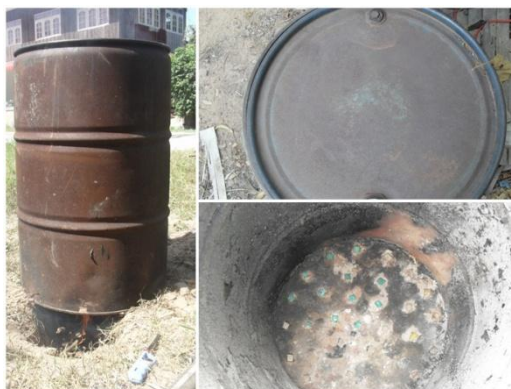
รูปที่ ก-12 ส่วนประกอบของเตาเผาถ่าน 200 ลิตร (แบบตั้ง)
