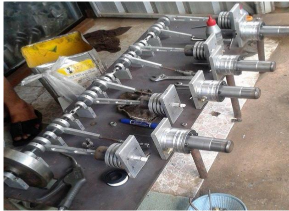
รูปที่ 3.12 ประกอบชุดลูกสูบร้อน
