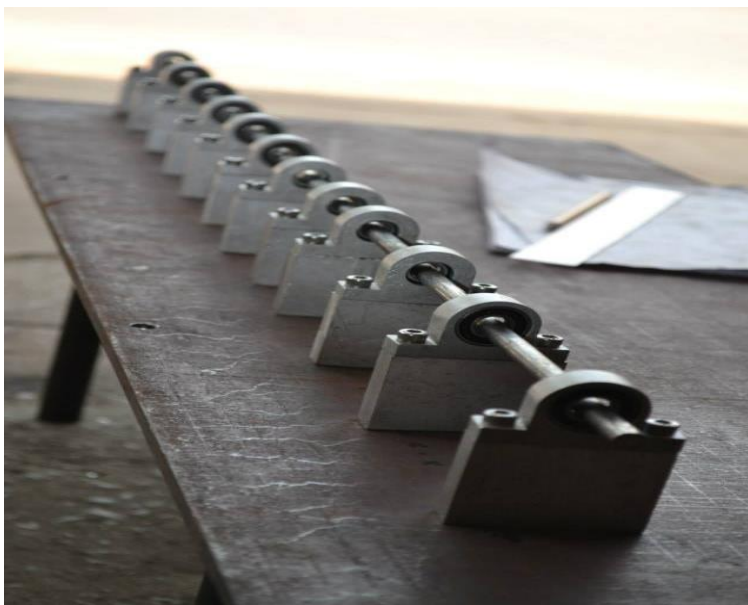
รูปที่ ข.1 ทำการประกอบตุ๊กตาเข้ากับฐานเครื่องยนต์สเตอร์ลิง
