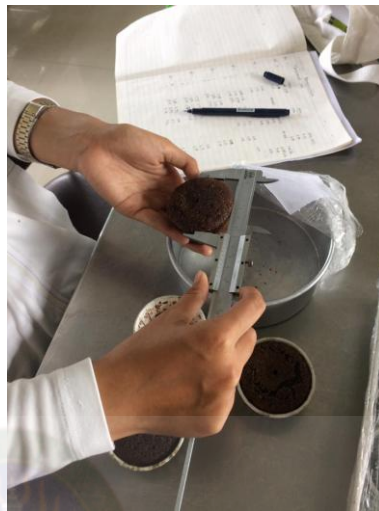
การวัดความกว้างด้วย Vernier Caliper
