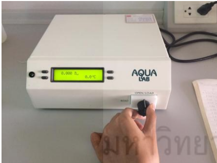
หมุนปุ่มไปที่ READ เพื่อให้เครื่องอ่านค่า
