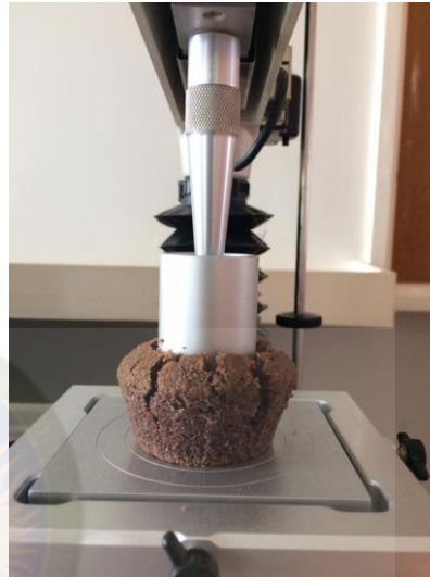
เครื่อง Texture Analyzer ทำการวัดเนื้อสัมผัส
