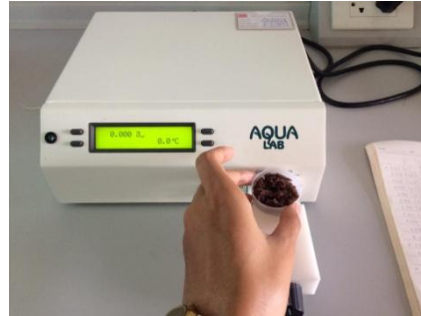
นำตัวอย่างใส่เครื่อง Water Activity Meter
