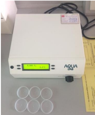
เปิดเครื่อง Water Activity Meter ก่อนใช้งาน 15 – 30 นาที
