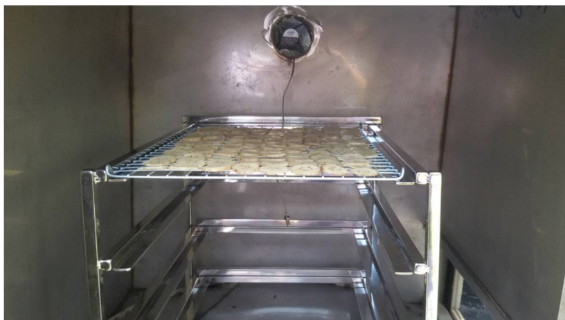
ภาพที่ 4.12 การอบแห้งกล้วยในขณะที่ภายในเตาอบแห้งพลังงานแสงอาทิตย์ร่วมกับรังสีอินฟราเรด
