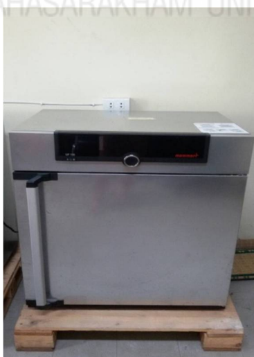
ภาพที่ 3.8 ตู้อบความชื้นของผลิตภัณฑ์แบบลมร้อน
