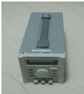
ภาพที่ 3.16 แหล่งจ่ายพลังงานไฟฟ้า
