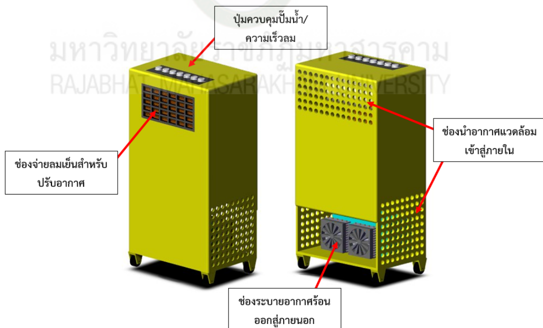
ภาพที่ 3.1 เครื่องปรับอากาศแบบพัดลมไอเย็นโดยใช้ชุดทำน้ำเย็นเทอร์โมอิเล็กทริก
