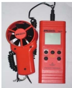
ภาพที่ 3.13 เครื่องวัดความเร็วลมแบบใบพัด
