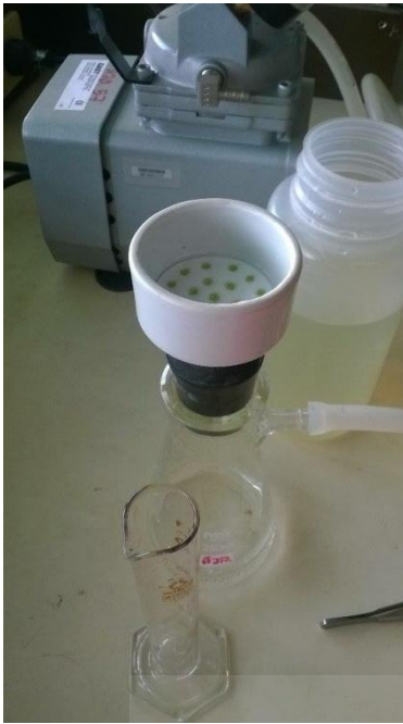
ภาพที่ ค-20 วิเคราะห์ของแข็งแขวนลอย ด้วย Buchner Funnel
