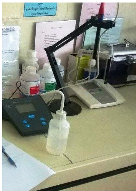
ภาพที่ ค-17 วิเคราะห์ค่าการนำไฟฟ้า ด้วยเครื่อง EC
