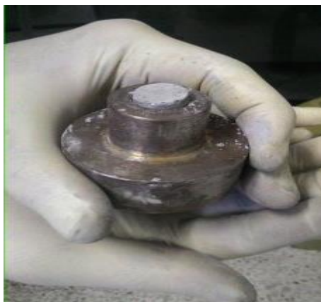
รูปที่ 3.8 เม็ด CNT/Al ที่ได้จากการอัดเม็ด
