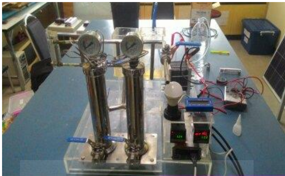
รูปที่ 4.3 ภาพการสร้างเครื่องผลิตก๊าซไฮโดรเจนจากวัสดุผสมอลูมิเนียมกับตัวเร่งปฏิกิริยาฟอนาโนคาร์บอน
