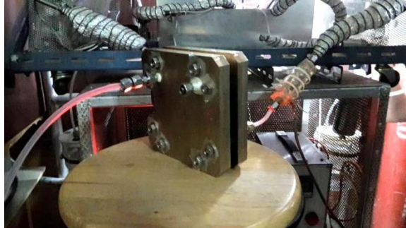
รูปที่ 3.11 ทดสอบประสิทธิภาพด้วยเครื่อง Fuel cell test station
