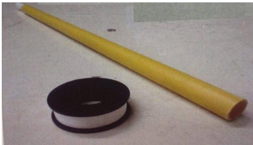
รูปที่ ค-3 เทปขาวพันเกลียวและท่อพลาสติก เส้นผ่านศูนย์กลางภายในขนาด 25 มิลลิเมตร
