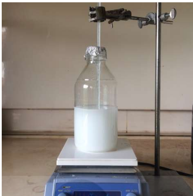
ภาพที่ ค.8 กวนวัสดุผสม \text{TiO}_2\text{-SiO}_2 เป็นเวลา 19 ชั่วโมง
