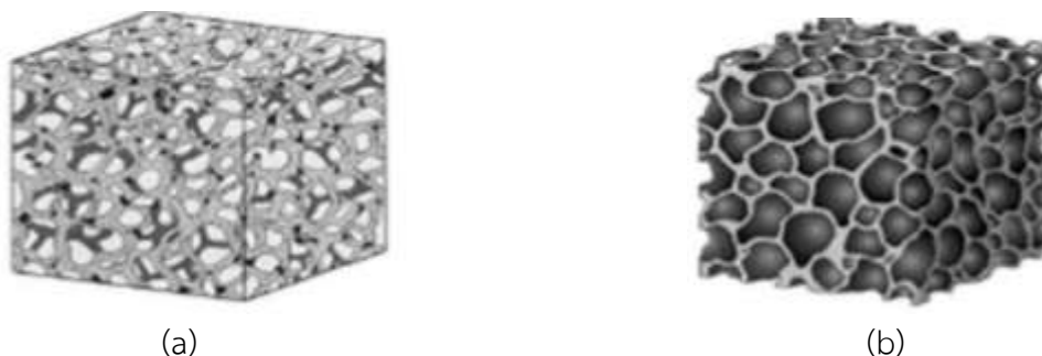
ภาพที่ 2.3 ลักษณะโครงสร้างของรูพรุนซิลิกา รูพรุนซิลิกาชนิดแบบเปิด (a) รูพรุนซิลิกาชนิด
