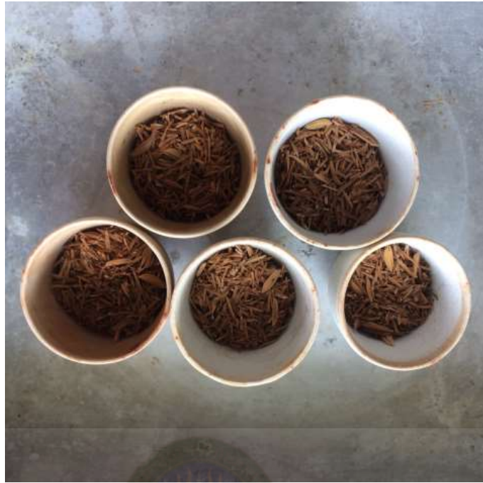
ภาพที่ ค.4 นำแกลบข้าวใส่ในครูชีเบิล เผาที่อุณหภูมิ 90 องศาเซลเซียส เป็นเวลา 6 ชั่วโมง
