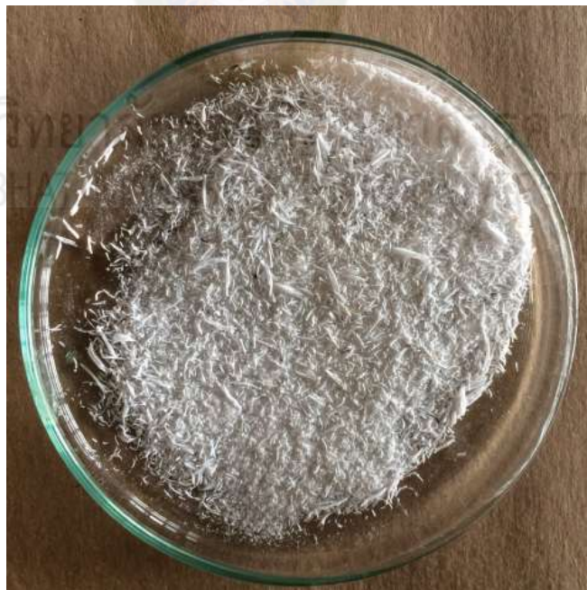
ภาพที่ ค.5 ซิลิกาจากแกลบข้าวมีลักษณะเป็นผงสีขาว
