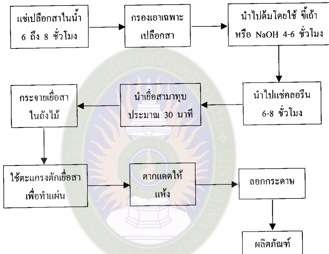
รูปที่ 2.8 แสดงขั้นตอนการทำกระดาษสาแบบพื้นบ้าน ที่มา : http://www.geocitics.com/sapapers/index.html
